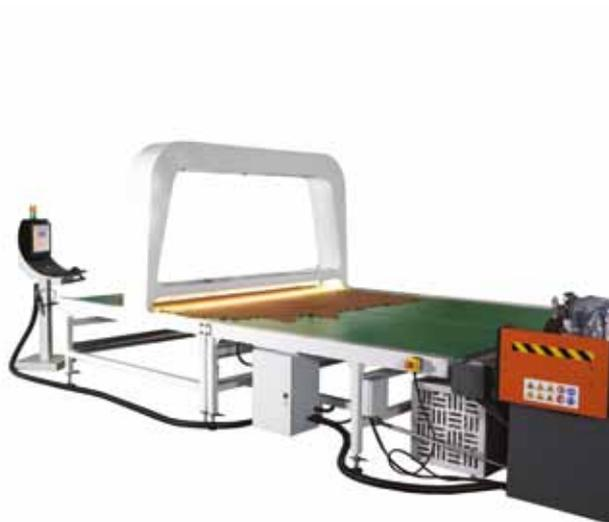
I modelli IntelliScan sono in grado di acquisire il contorno e le aree di qualità delle pelli premarcate in modo automatico e in qualsiasi condizione di luce ambiente. Disponibili sia in versione fuori linea sia in quella in linea integrata a vari sistemi di taglio a lama, i modelli IntelliScan sono largamente utilizzati nei settori dell'arredamento e dei rivestimenti interni per auto.
