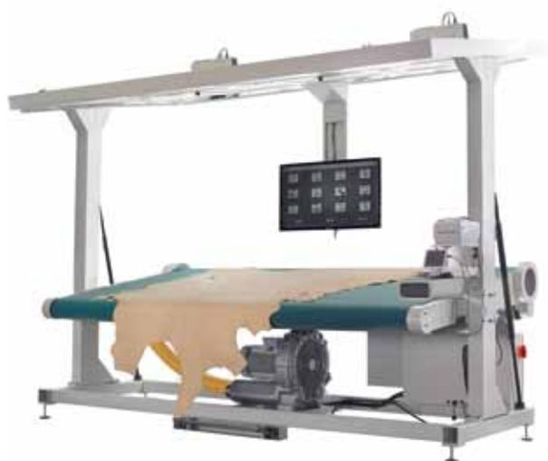
I modelli IntelliView acquisiscono automaticamente il contorno della pelle di qualsiasi tipo e colore. Il sistema di illuminazione e l'esclusiva penna ottica Flash Tracer permettono all'operatore di ispezionare con facilità la pelle e di marcare rapidamente le aree di qualità. La gamma IntelliView dispone di modelli con piano aspirato e tappeto di trasporto.
